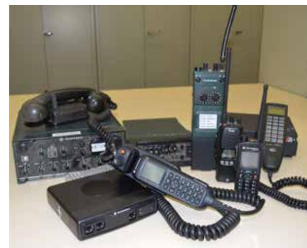
Das neue digitale Fahrzeugfunkgerät und das Handfunkgerät im Vordergrund ersetzen die alte analoge Funktechnik
