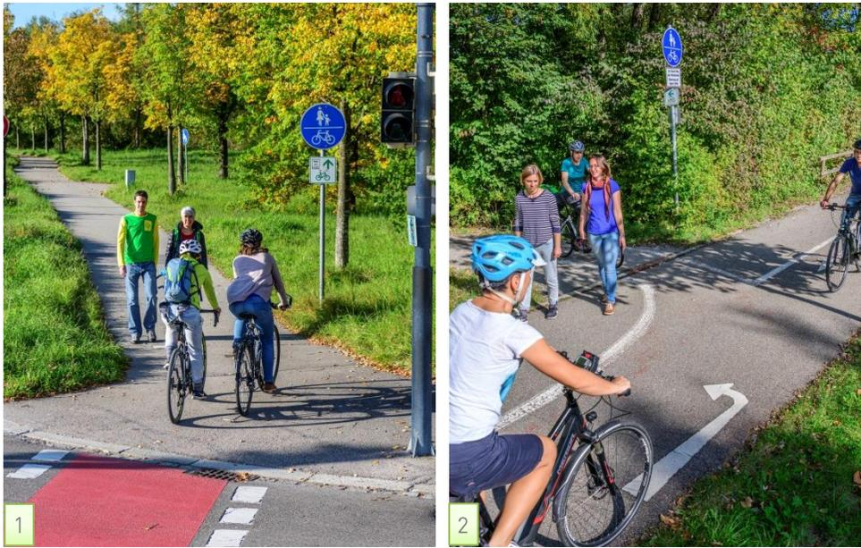
**Bild 1:** Der Radverkehr wird von der Fahrbahn kommend auf einen gemeinsamen Geh- und Radweg geleitet. Zwei nebeneinander gehende Fußgänger beeinträchtigen die Radfahrenden. Die Radfahrenden müssen bereits auf der Fahrbahn – im Kreuzungsbereich – abbremsen. Noch stärker abbremsen müssten Radfahrende, wenn bei roter Fußgängerampel wartende Fußgänger den Bereich blockieren. Das ist nicht nur ärgerlich sondern bei einem Wechsel der Ampelschaltung durchaus auch gefährlich.
